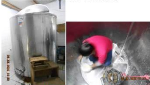
Setor de ordenha – Tanque de resfriamento e limpeza do tanque
